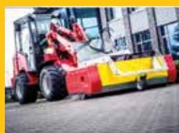
Al levantar las cubiertas laterales es posible barrer a ras de pared y por lo tanto, no es necesario comprar un caro cepillo lateral. El giro hidráulico del aparato se lleva a cabo mediante un cilindro incorporado de serie.
